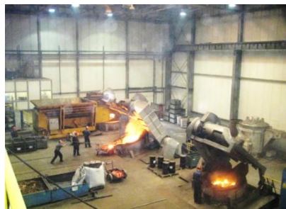
(Fig. 3) Vaciado de hornos a ollas en una planta similar
